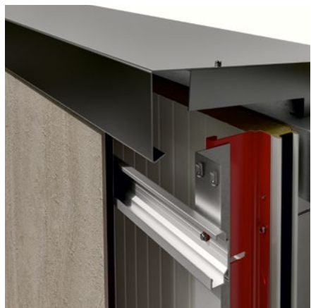
Détails de la section verticale supérieure
