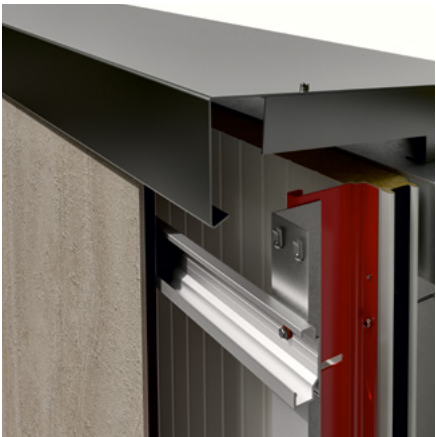
Détails de la section verticale supérieure
