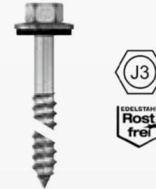
Befestigungsschraube Ø 6,5 mm aus Edelstahl mit Dichtscheibe 16 mm (E16) oder 22 mm (E22) S ≤ 2 mm für Stahlunterkonstruktionen
