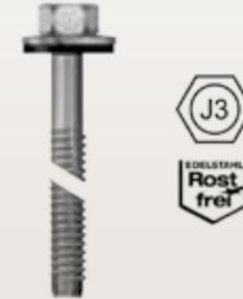
Befestigungsschraube Ø 6,3 mm aus Edelstahl mit Dichtscheibe 16 mm (E16) oder 22 mm (E22) S ≤ 2 mm für Stahlunterkonstruktionen
